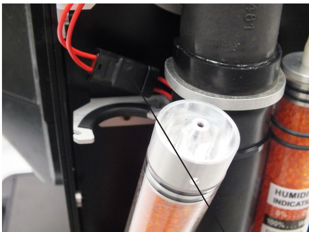
Connecteur sur câble (bras sans verrouillage)
