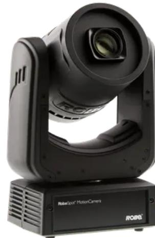
Bestückt ist das Moving-Light mit einer Full-HD Kamera mit hoher Lichtempfindlichkeit bis 0,3 Lux Restlicht. Es ermöglicht dem Operator einen genauen Überblick über die Bühne, so dass er in der Lage ist, die Künstler optimal ins Verfolgerlicht zu setzen. In Echtzeit wird das Videosignal der Kamera über ein Hochgeschwindigkeits-Ethernet Cat5-Kabel mit nur minimalster Verzögerung auf die RoboSpot BaseStation übertragen.
