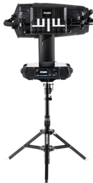
Das System erlaubt die Montage entweder an der Seite oder Rückseite. Der Bügel verfügt über zwei programmierbare Fader (z.B. für Dimmer und Iris), ein Bedien-Panel mit Touch-Screen Display und vier frei belegbare Dreh-Encoder, sowie zehn frei belegbare Taste für ein komplett individualisierbares Bedienerlebnis.
