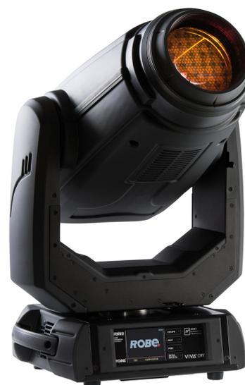
Der elegante und leichte VIVA CMY ist vollgepackt mit intelligenten Effekten bei einer absolut benutzerfreundlichen Bedienung. Dieser Scheinwerfer strotzt vor Kraft - verbraucht aber nur wenig Energie. Die 350W LED Weißlichtquelle erzeugt einen durchschlagenden Beam bei exzellenter, gleichmäßiger Ausleuchtung und ist mit zu erwartenden 20.000 Betriebsstunden so langlebig, dass sich ein Leuchtmittelwechsel während der gesamten Nutzungsdauer des VIVA CMY erübrigt!
